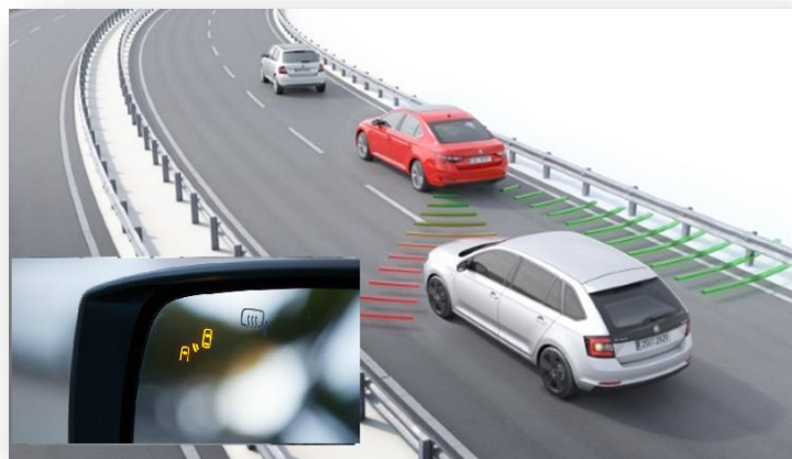
شکل ۱۰: نحوه عملکرد سیستم پایش نقاط کور خودرو
